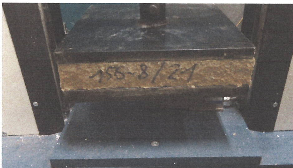
Рисунок 5 – Проведення випробування та типова експериментальна залежність міцності на стиск при 10% деформації зразків теплоізоляційного матеріалу марки «ТЕХНОРУФ Н ОПТИМА»
