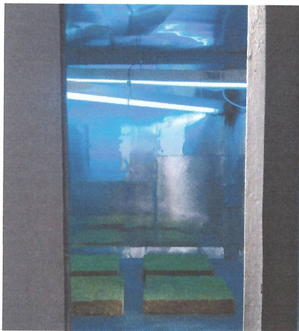
Рисунок 7 – Загальний вигляд дослідних зразків теплоізоляційного матеріалу марки «ТЕХНОРУФ Н ОПТИМА» під час опромінення
